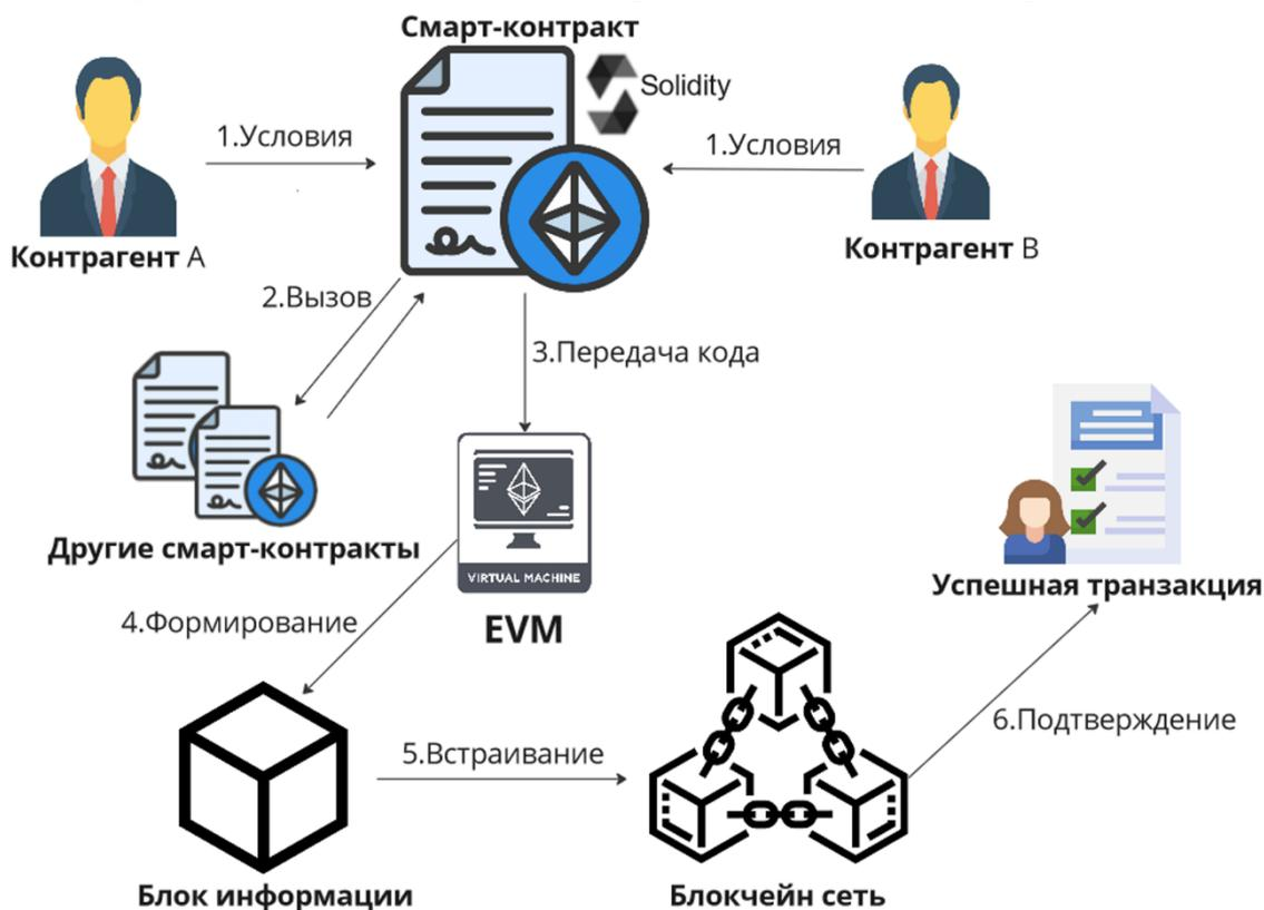
Рис. 1. Этапы функционирования и элементы смарт контрактов
